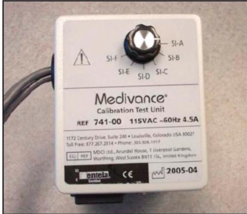
Fig. 9-1 Unidad de prueba de calibración
