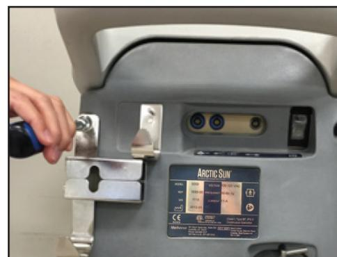
Fig. 8-73 Asegure el soporte (paso 2)
