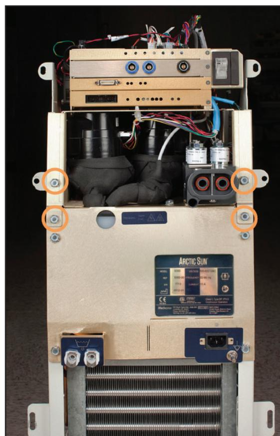
Fig. 8-16 Retire los cuatro pernos (paso 1)
