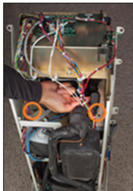
Fig. 8-17 Retire los dos pernos (paso 2)
