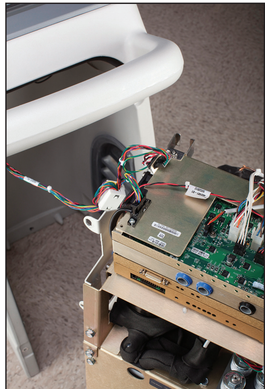
Abb. 8-12 Zu entfernende Kabelbäume (Schritt 3)
