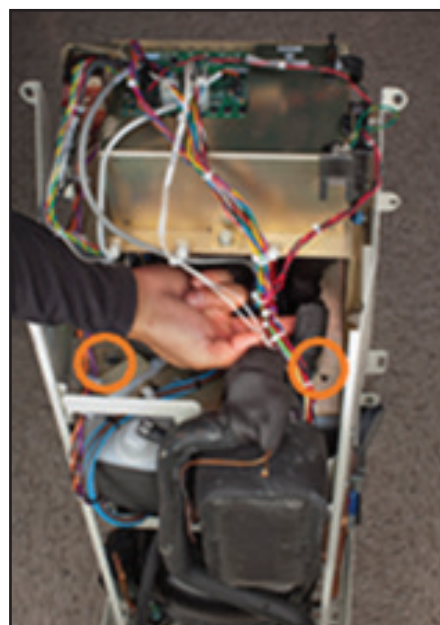
Abb. 8-17 Entfernung von zwei Schrauben (Schritt 2)
