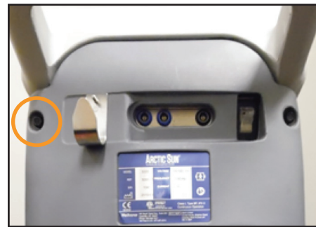
Abb. 8-72 Entfernen der Schraube (Schritt 1)
