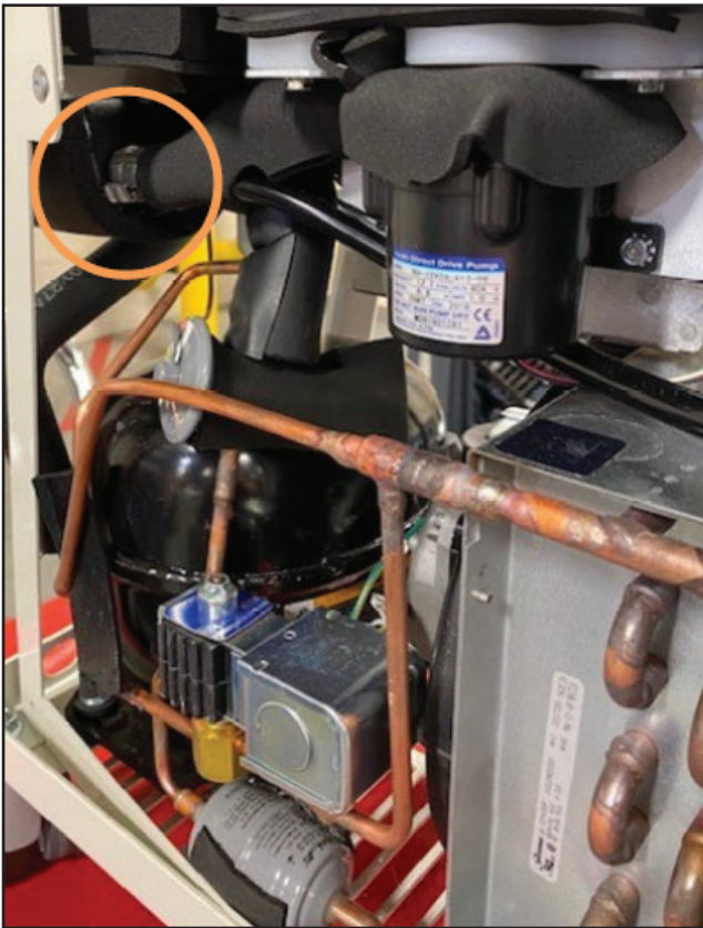
Abb. 8-22 Lösen von zwei Klemmen (Schritt 3 – DC-Pumpe)
