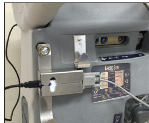
Abb. 8-74 Einsetzen des Übertragungsschnittstellenmoduls und Anschließen der Kabel (Schritte 3-5)
