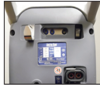
Abb. 9-2 Anbringen des Kalibrierungsprüfgeräts (Schritt 1)
