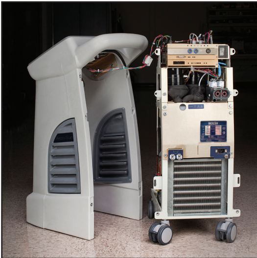
Abb. 8-13 Gehäuse getrennt von internen Komponenten
