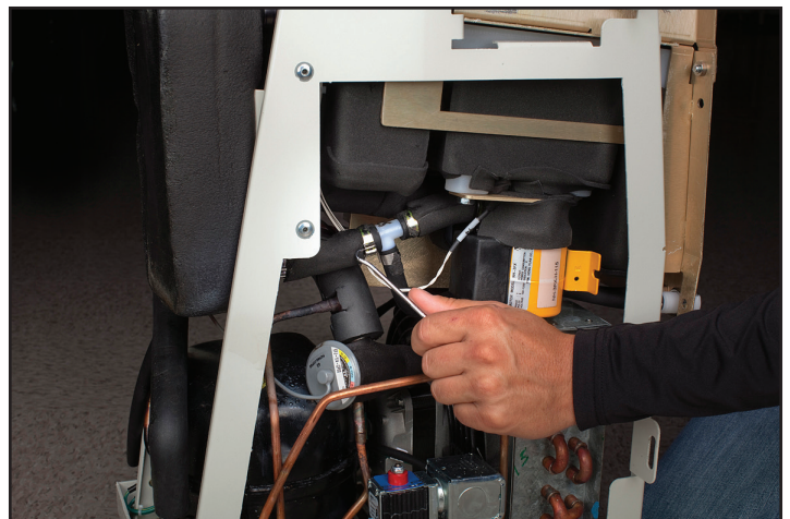
Abb. 8-21 Öffnen des Schnappverschlusses (Schritt 3 –AC-Pumpe)
