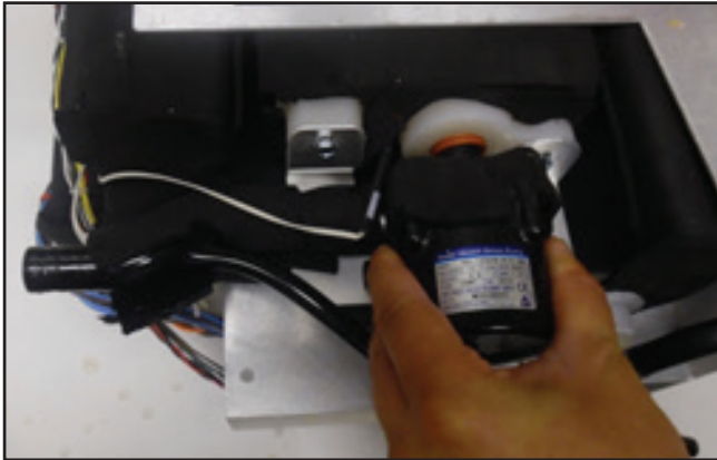
Abb. 8-47 Wiedereinbau der Pumpe (Schritt 6) (zwei Ansichten)
