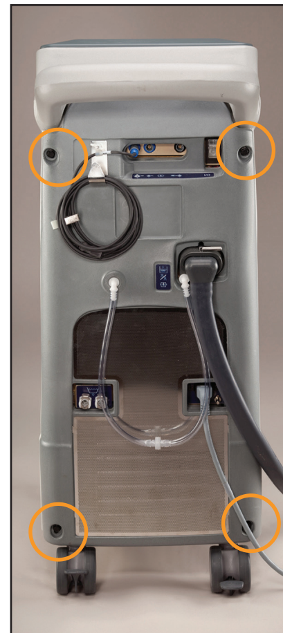
Kuva 8-10 Takapaneeli, johon on merkitty irrotettavat pultit (vaihe 2, vasen)
