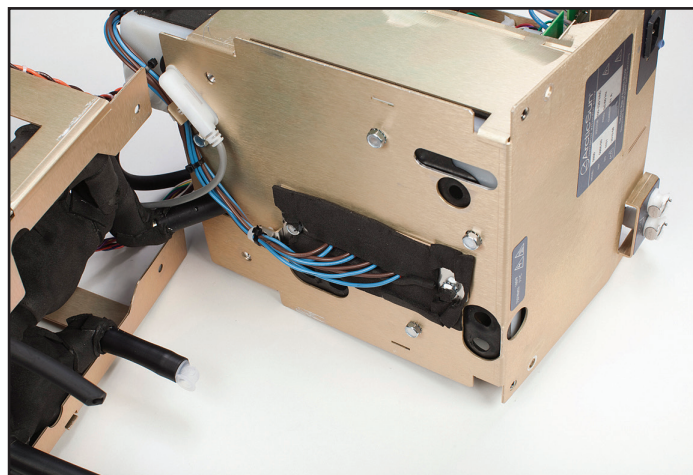
Kuva 8-49 Säiliö ja lämmitin, jossa on merkintä irrotettavista nippusiteistä (vaihe 2)
