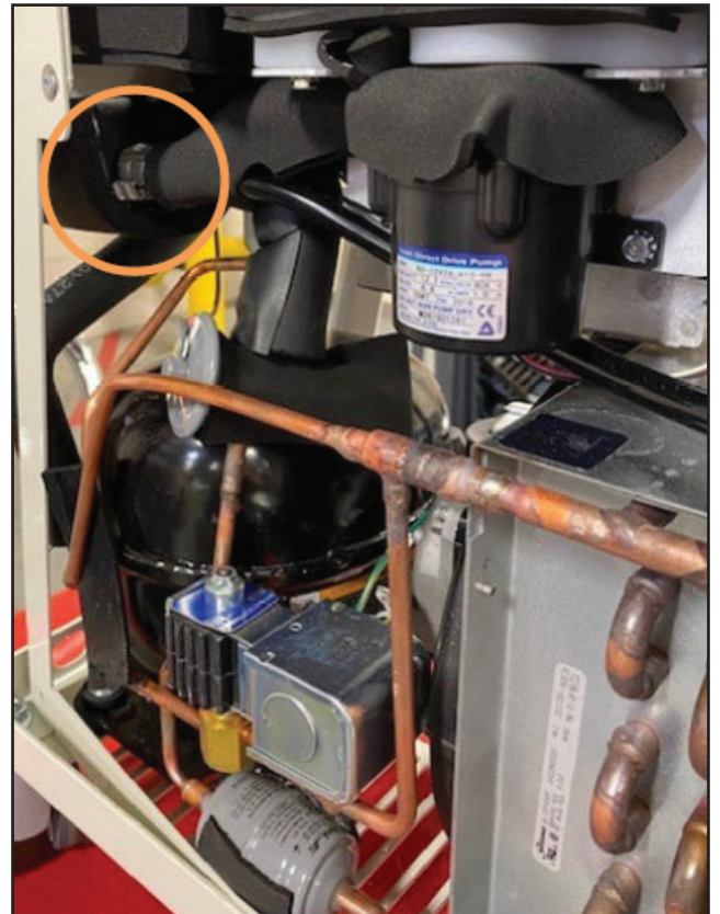
Kuva 8-22 Irrota kaksi puristinta (vaihe 3, tasavirtapumppu)
