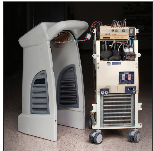
Kuva 8-13 Kuori erotettu sisäkomponenteista
