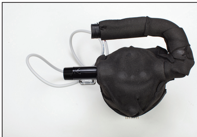
Slika 8-53 Mjerač protoka sa strelicom smjer protoka, isti smjer kao i izlaz cirkulacijske pumpe
