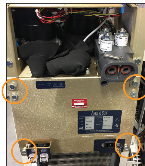
Slika 8-36 Uklanjanje šest vijaka (3. korak)
