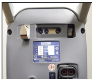
Slika 9-2 Pričvršćivanje jedinice za ispitivanje kalibracije (1. korak)
