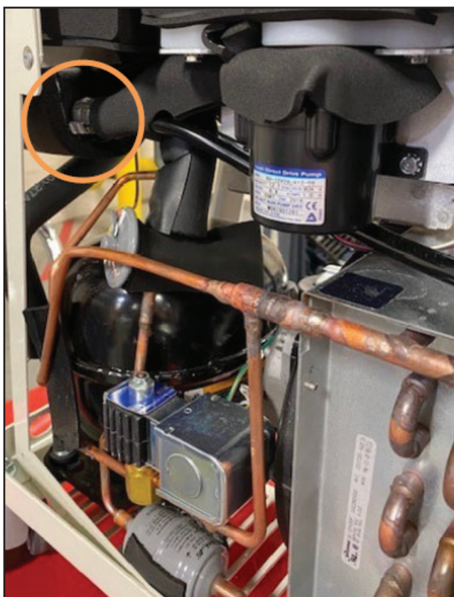
Slika 8-22 Odspajanje dvije stezaljke (3. korak – pumpa istosmjernog napona)
