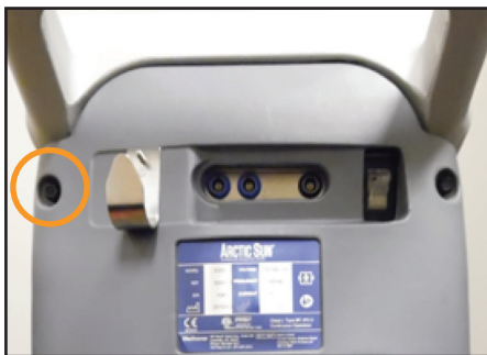
Slika 8-72 Uklanjanje vijaka (1. korak)
