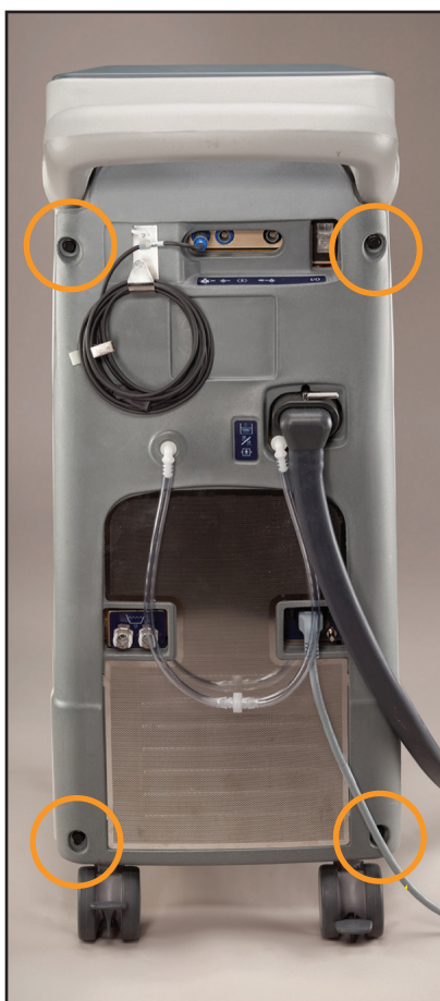
Slika 8-10 Stražnja ploča s označenim vijcima koje treba ukloniti (2. korak, lijevo)
