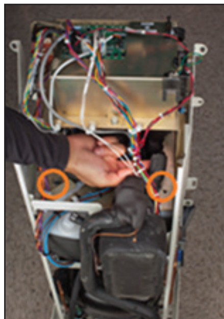
Slika 8-17 Uklanjanje dva vijka (2. korak)
