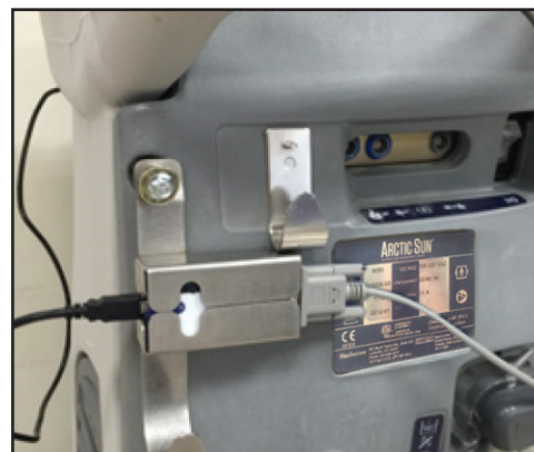
Slika 8-74 Umetanje TIM-a i spajanje kabela (od 3. do 5. koraka)
