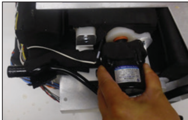
Slika 8-47 Ponovna ugradnja pumpe (6. korak) (dva prikaza)
